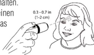
5. Drücken Sie die Multifunktionstaste, um eine Messung durchzuführen.
